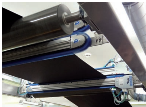
Abb.3: Lage der von links bzw. rechts eingreifenden Bürstenpaare auf der Papieroberfläche.
