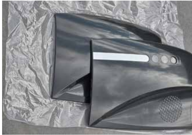
Bild 2. Demobauteil vorher und nachher: Im Hintergrund werkzeugfallend vor dem Folienbeschnitt, im Vordergrund beschnitten und bedruckt
