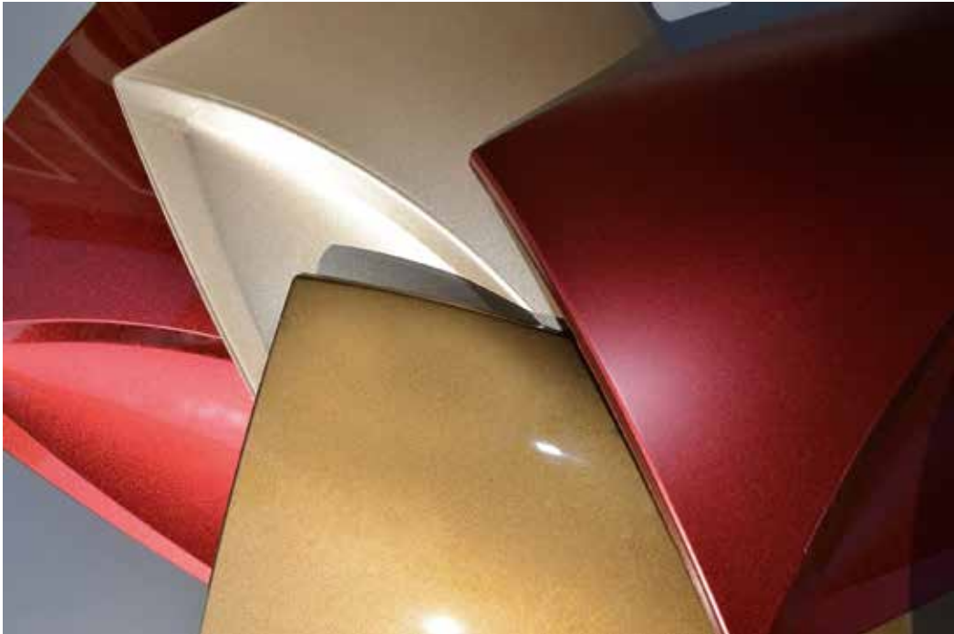
Lackierte PP-Bauteile: Als Haftvermittler diente jeweils eine mehrlagige Folie aus Polypropylen- Lage, Haftvermittler und polarer TPU-Schicht
