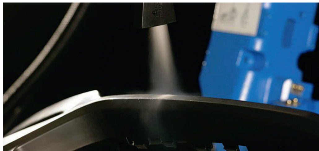
Durch Roboter geführte Flachdüse bei der Bauteilreinigung mit CO 2 -Schnee.
