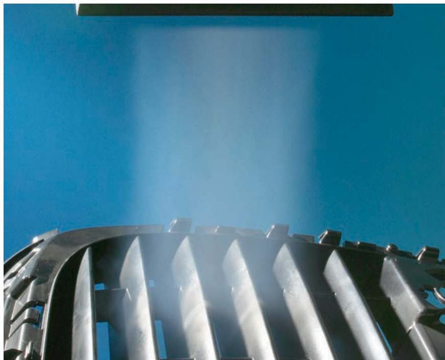
Bild 1 > Flachstrahldüse beim Reinigen eines Bauteils vor der Lackierung.
