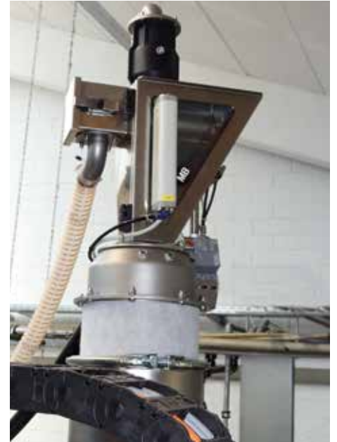
Bild 4. Sichtermodul TS5 zur Entstaubung des PMMA-Granulats bei neo-plastic im Serieneinsatz (© Ingenieurbüro Fischer)
