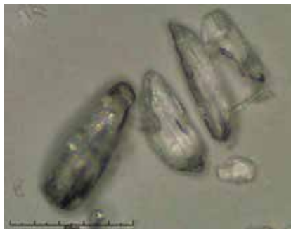
Bild 2. Mikroskopische Aufnahmen: links Großaufnahme von einigen Staubpartikeln, rechts Ausschnitt vom Partikelfilter, der mit dem Schnittstaub belegt ist (© CleanControlling)
