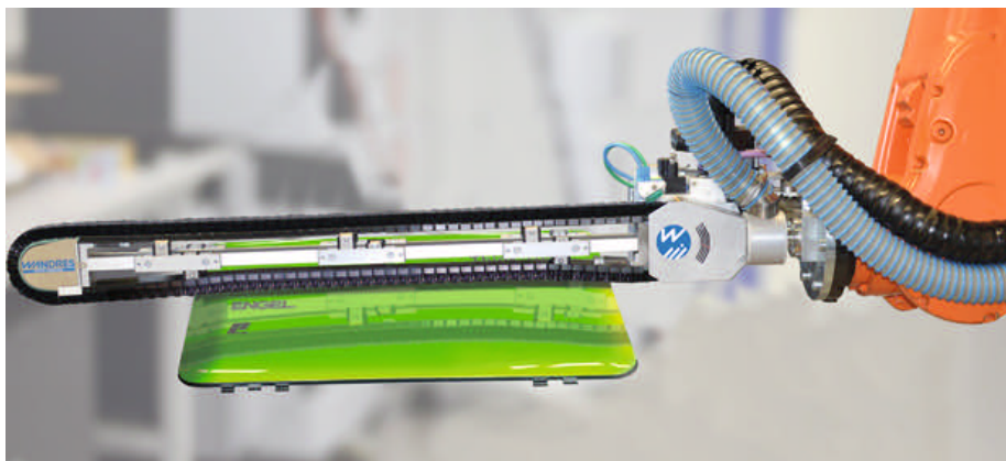
Eine aktuelle Anwendung aus dem Hause Engel: hinterspritzte Laptopabdeckung, die vor dem Einlegen in das Werkzeug beidseitig mit einer Schwertbürste von Partikeln gereinigt wird (Bilder: Wandres)
