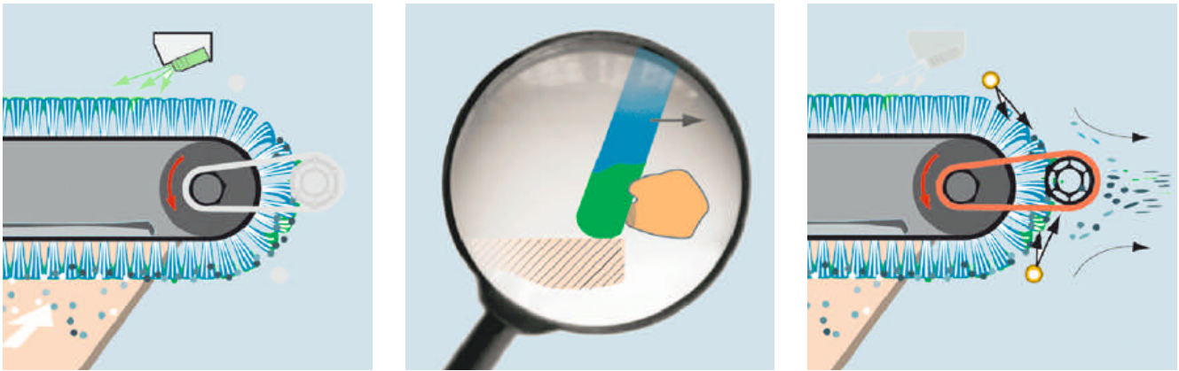
Bild 1. Das Ingromat-Reinigungsverfahren: Die mit einer antistatischen Flüssigkeit benetzte Bürste löst Schmutzpartikel von der Oberfläche, transportiert sie ab und wird im Umlenkbereich selbst gereinigt
