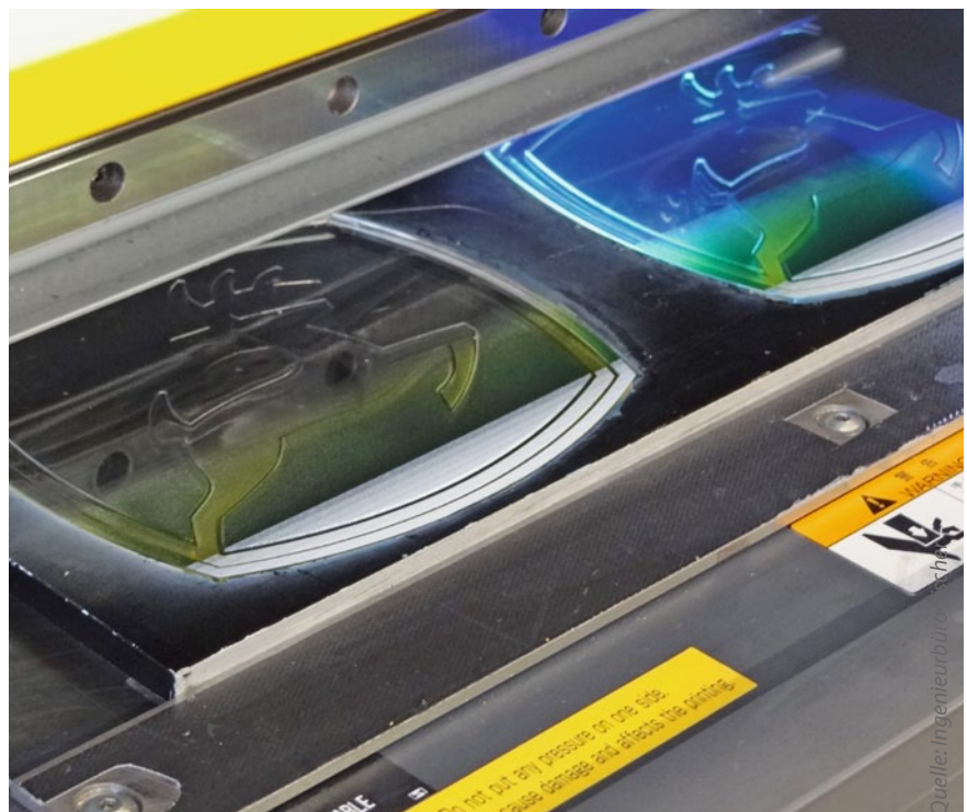
Bild 2: Zweifarbiges Digitaldruck für das Emblem des Landmaschinenherstellers John Deere. Die vertieften Konturen bleiben ausgespart.
