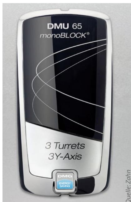
Bild 1: Beispiel für eine Produktkennzeichnung mit kombinierten Dekorationsstechniken. Dabei wurde der Rahmen galvanisiert, die Kunststoffteile silbern lackiert und bedruckt sowie zusätzlich ein Fenster rückseitig bedruckt.
