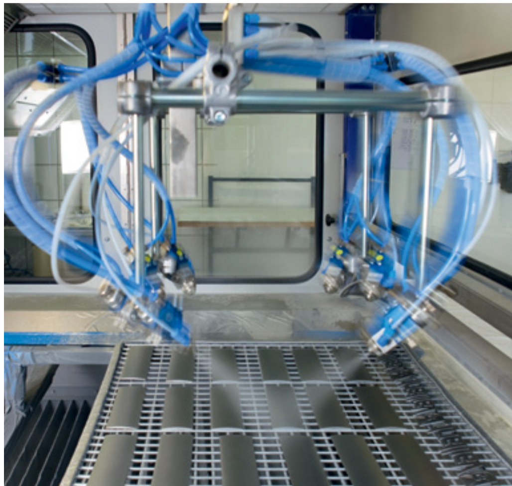
Die vier Spritzapparate applizieren den Basislack. Wenn es erforderlich ist, wird in einem zweiten Schritt der Klarlack aufgetragen.
